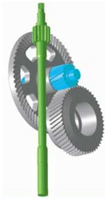
Bild 9. Antriebsschema in der Webmaschine.
